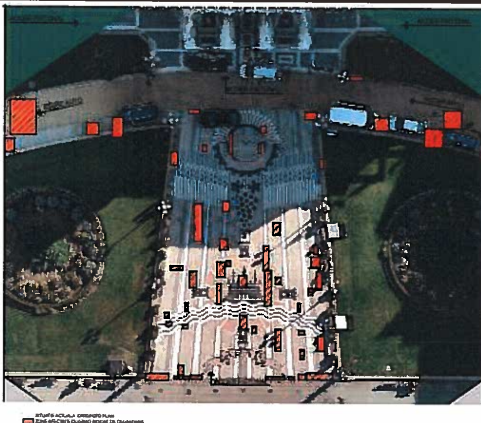
Fig. 3. Situația suprafețelor afectate de defecțiuni de pe platou
